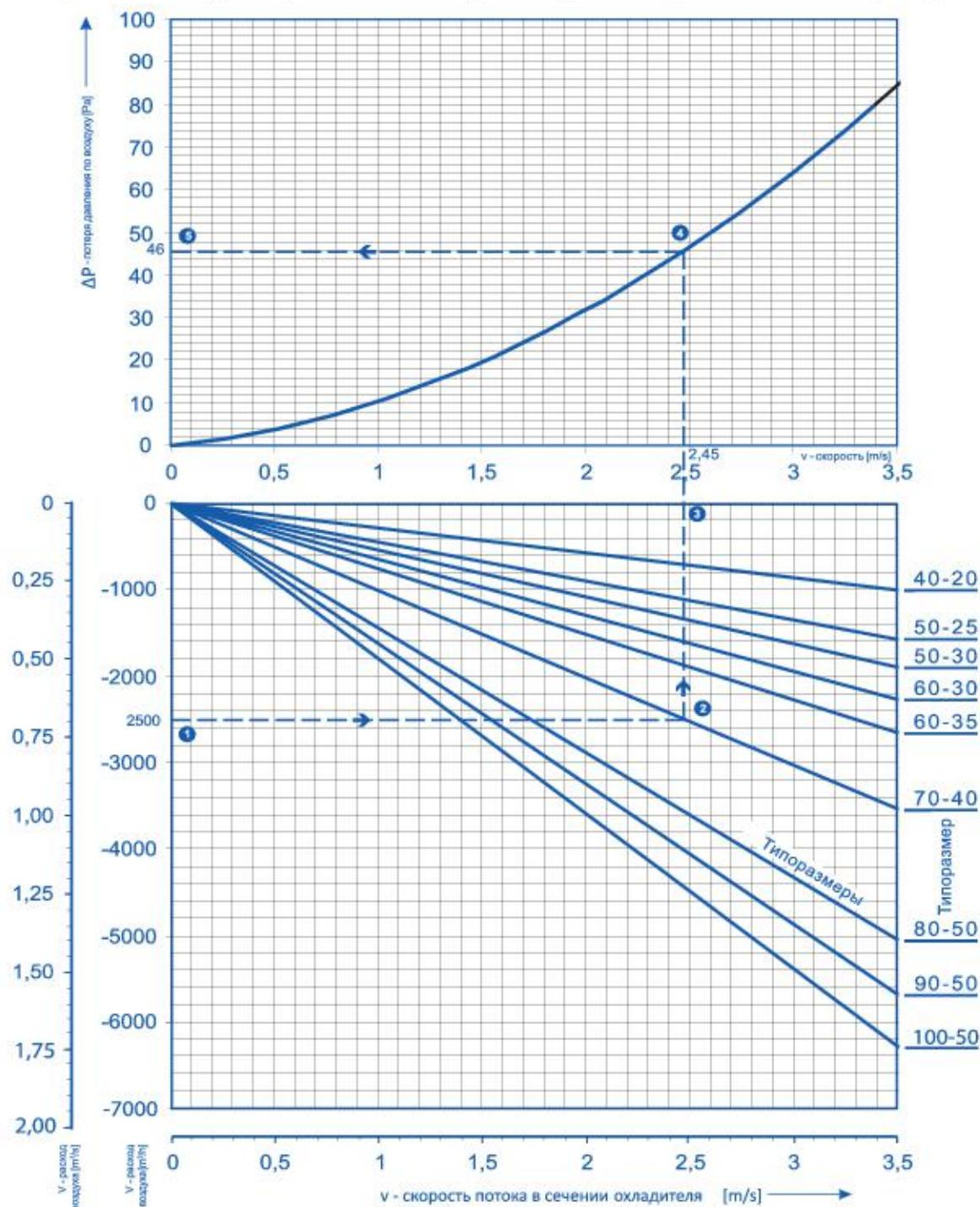
Номограмма потерь давления действительна для всех охладителей. Для заданного расхода воздуха ① можно по нижнему графику определить скорость потока ③ в свободном сечении охладителя ② и, впоследствии, по известной скорости можно в верхней части ④ определить соответствующую потерю давления охладителя по воздуху ⑤.
